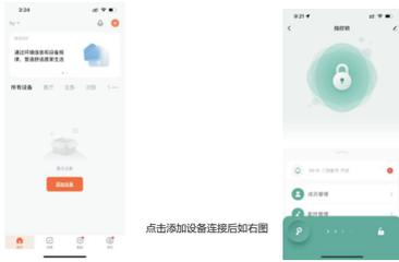
备注: 已连过涂鸦APP并注册了管理员, 手机有正常网络并开启蓝牙, 在APP中找到该设备点击并用任意手指按压智能锁的指纹头唤醒设备, 实时连接后进行操作即可
