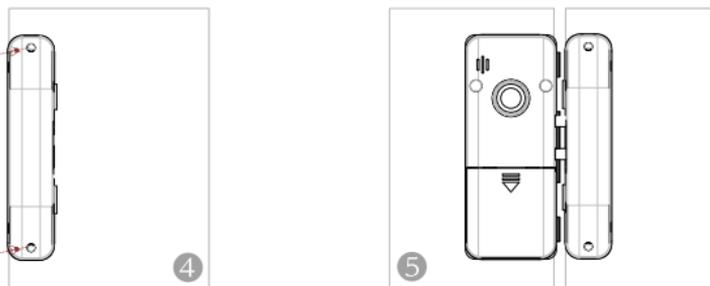
4. 副锁卸下后壳(上下两颗螺丝)，从玻璃侧边推入，并拧上固定螺丝
