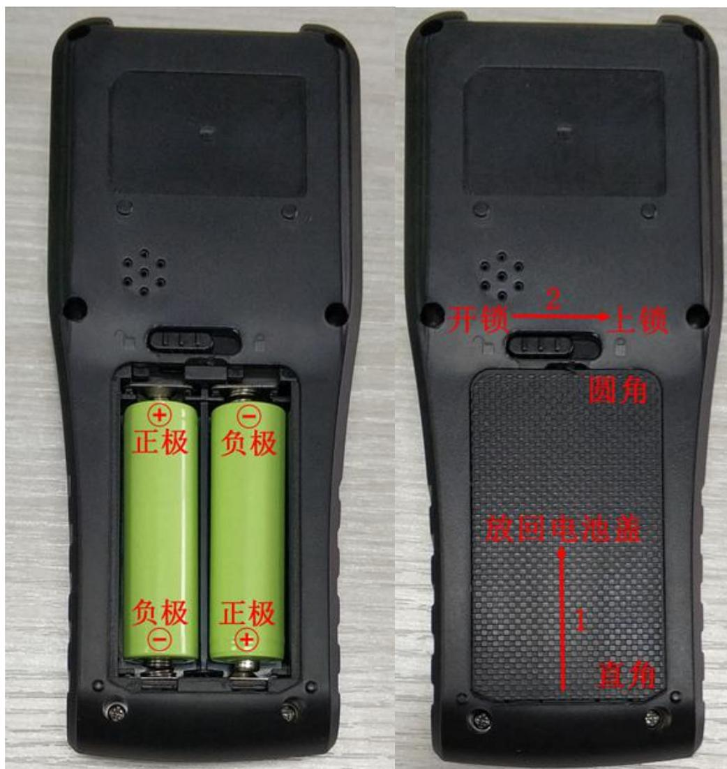
1.3.3 装回电池盖。请将电池盖放到机器背面，请注意电池盖直角是在下方，电池盖圆角是在上方，放入电池盖后，记得把按钮拨向上锁方向，如上图所示。
