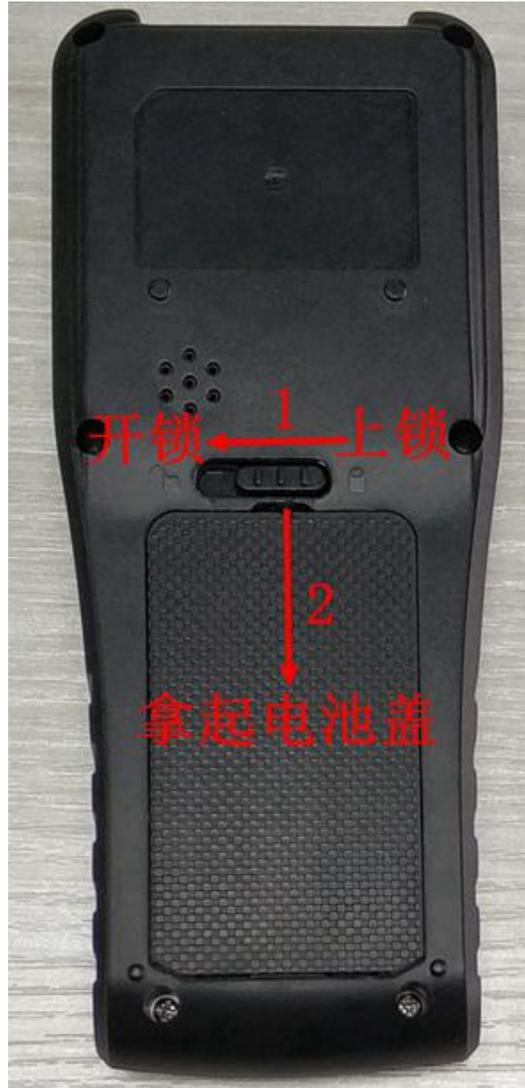
1.3.2 装入电池。确保电池正负极与机器正负极对应，如下图所示：
