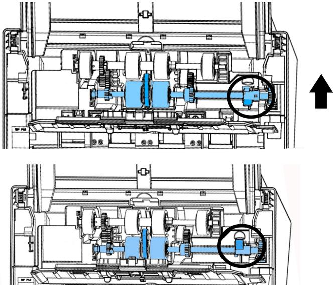
3. 关上自动进纸滚轮上盖，如果安装正确您会听到一个清脆的声响。
