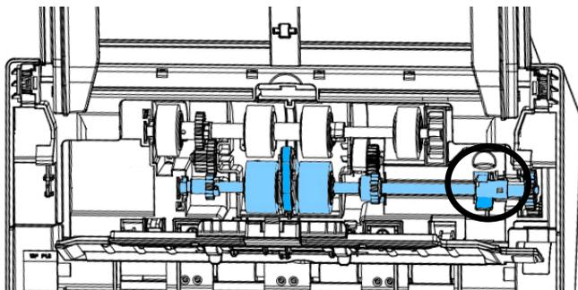
4. 从洞孔中先移除滚轮的右端，下方的自动进纸滚轮便可移除了。
