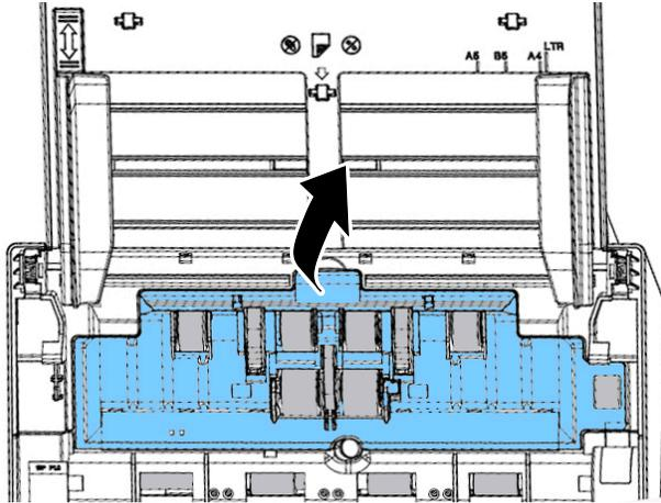
3. 将下方自动进纸滚轮右端的卡榫**往下**扳，如下图所示。
