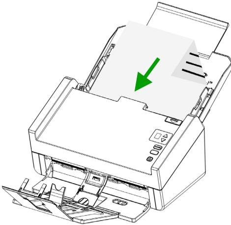
5. 请确定导纸板与输入纸张的边缘对齐。
