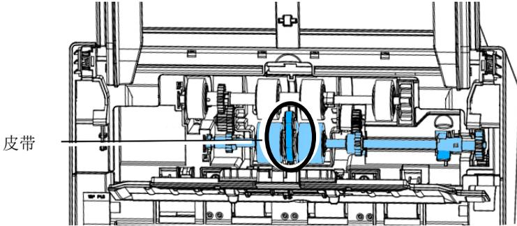
2. 将下方自动进纸滚轮插入洞孔，再将卡榫**往上**扳。
