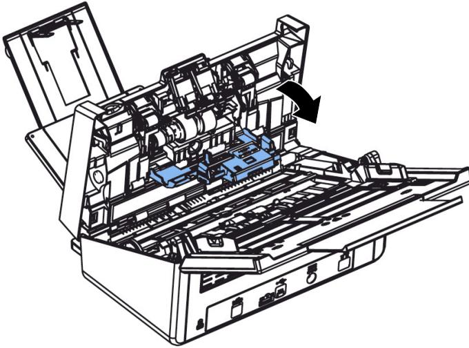
4. 按下反转轮右端，以便移出凹槽，然后从洞里移出反转轮的左端。
