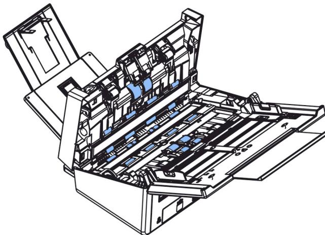
4. 用您的手指握住反转轮护盖的两边，接着将它放下，如下图所示。
