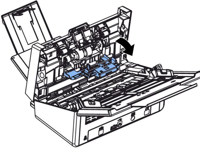
5. 擦拭反转轮，转动反转轮确定所有表面都已擦干净。
